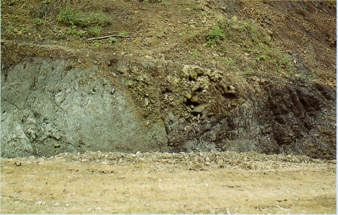
照片十八 斷層材料露頭之二，位於地滑區東界附近(80年11月中攝)
