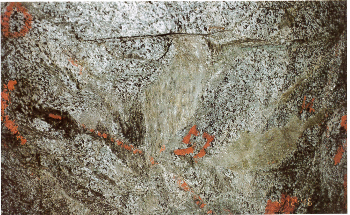
照片八 平洞（探查橫坑）內岩壁可見擦痕，但裂面緊閉
