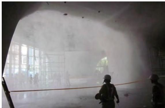
圖十四 水幕防火設備放水測試
