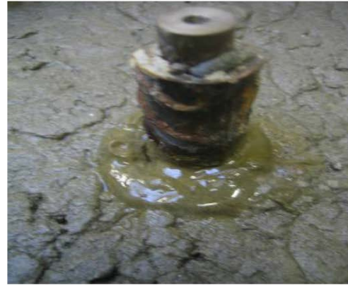
圖九 未經 EKG 處理脫水礦渣中土釘於拉出時其周圍土壤發生液化現象(Jones 等人，2008)
