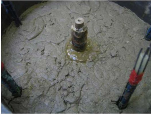
圖九 未經 EKG 處理脫水礦渣中土釘於拉出時其周圍土壤發生液化現象(Jones 等人，2008)
