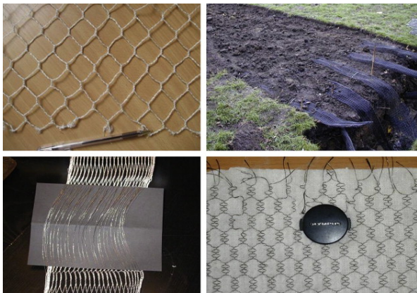
平板型電動能地工合成材料(Jones等人, 2008)
