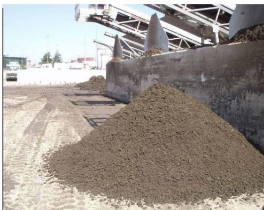
(b)EKG處理過程降低體積39%，固體含量31%
