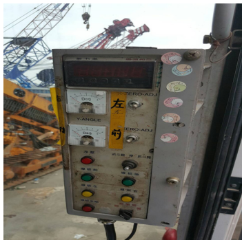
圖十二 履帶起重機SCX-900HD-2 駕駛室中加裝MHL控制箱
