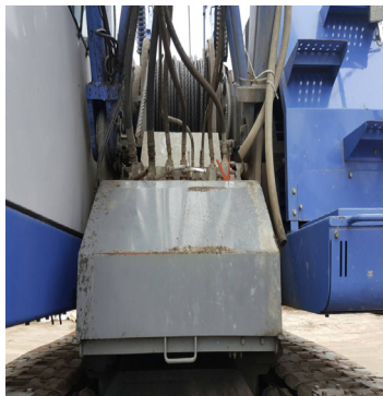
圖十 履帶起重機SCX-900HD-2 增加控制閥位置
