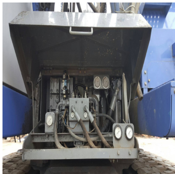
圖十一 履帶起重機SCX-900HD-2 增加控制閥及油管
