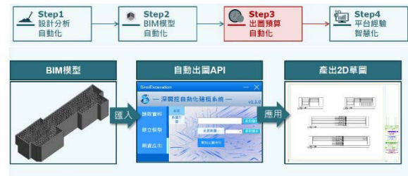
圖十一 深開挖BIM模型自動化出圖
