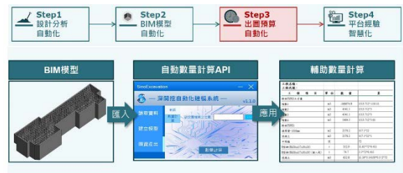
圖十二 深開挖BIM模型數量計算
