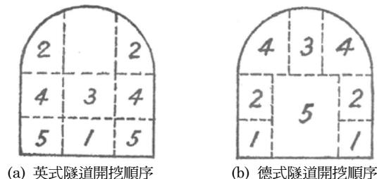
圖三 隧道開鑿順序示意圖(李，1991)
