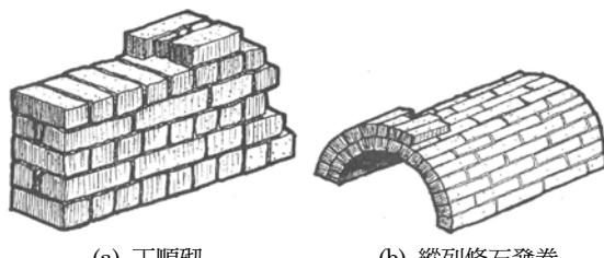
圖四 隧道襯砌方式示意圖(李，1991)
