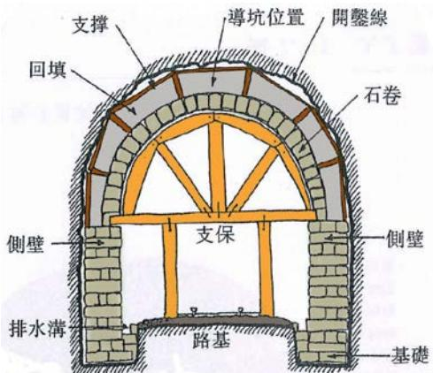
圖二 劉銘傳隧道開挖支撐與襯砌示意圖
