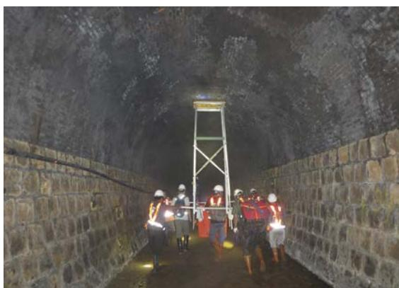
(d) 3D透地雷達探查(工程圖輯隊，2020)
