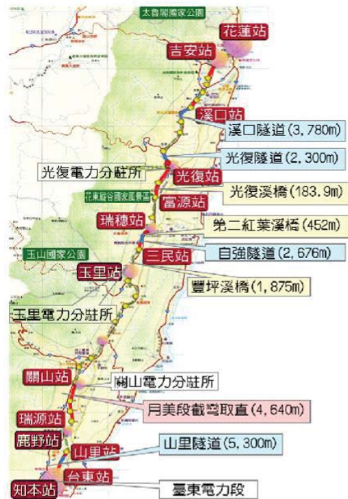
圖三十五 花東線鐵路瓶頸路段雙軌化暨全線電氣化計畫主要工程示意圖(交通部鐵道局，2019)
