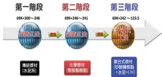
圖四十二 新自強隧道沉泥層區段工法演進圖(交通部鐵路改建工程局東部工程處，2018)
