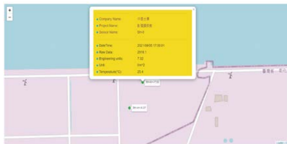
圖十 雲端監測軟體MAP顯示即時水壓力資訊
