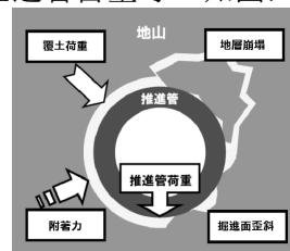
圖四 管周推進阻力構成示意圖
