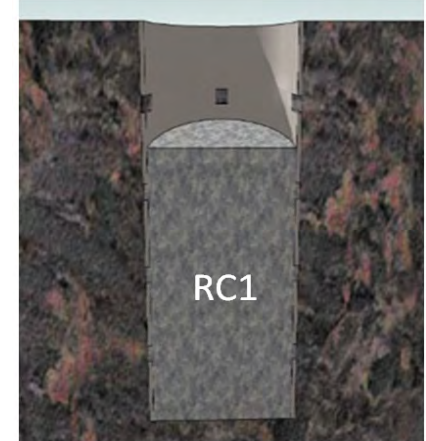
圖六 井式基礎混凝土套環澆置RC1
