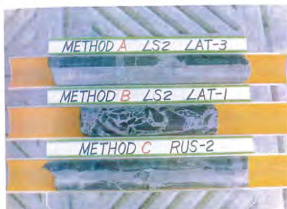
照片六 經 A, B, C 方法處理後鑽取之層縫岩心顯示處理結果良好
