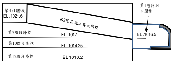
圖七 地下開關場長軸方向開挖順序示意圖
