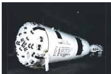
投影片 12 導坑TBM(Robbins)直徑4.8M
