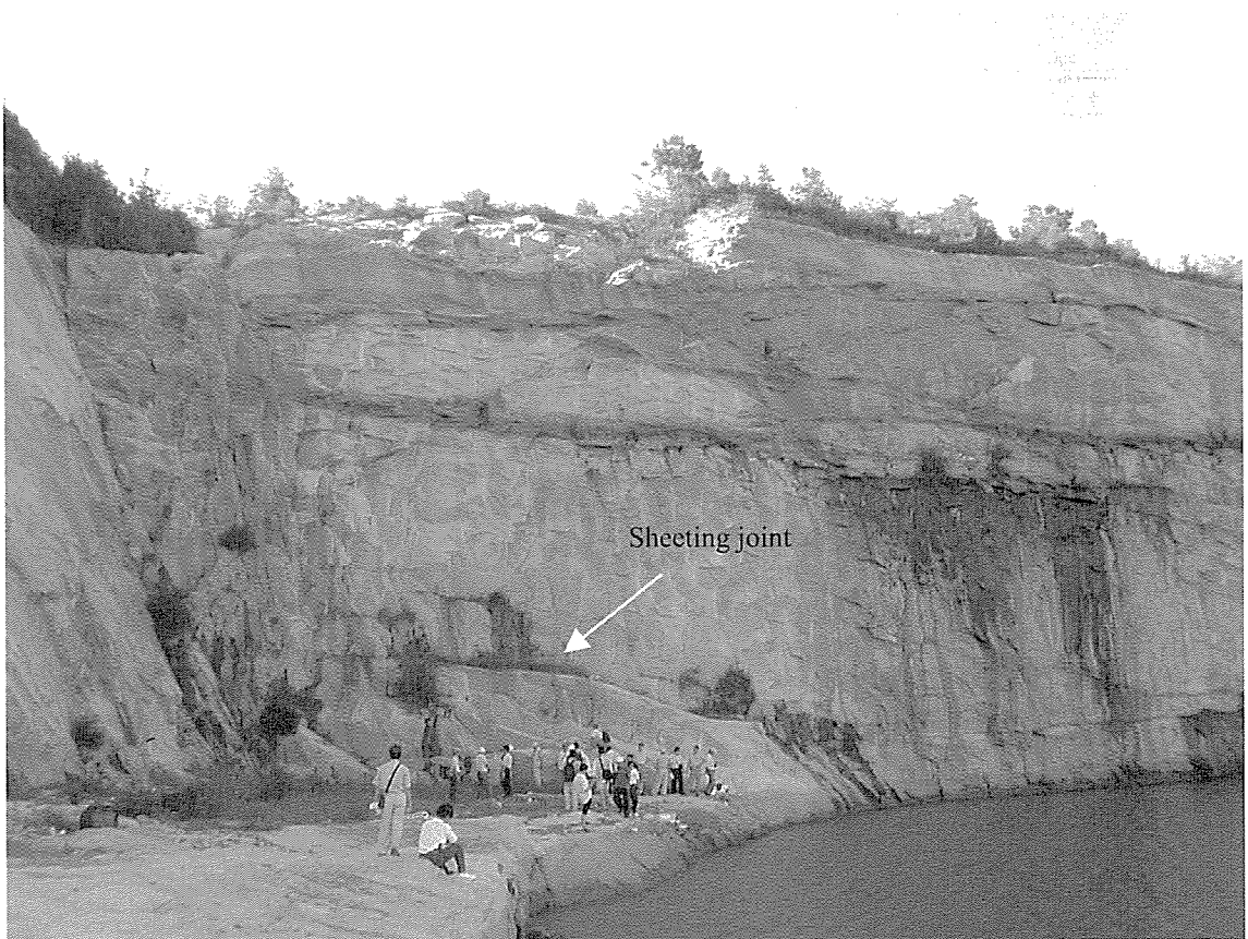
圖二 料羅採石場片麻岩露頭，露頭編號 5，圖中可見水平延伸良好之板狀節理 (sheeting joint)，地下水易沿此組節理滲出
