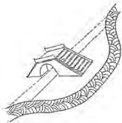
圖十八 河川改道(乾修法)(摘自茅以昇，中國古橋技術史)
