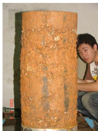
圖八 12 英吋大三軸試體(94/6/9)
