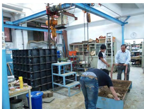
圖七 卵礫石地層推進縮尺模擬試驗(100/5)
