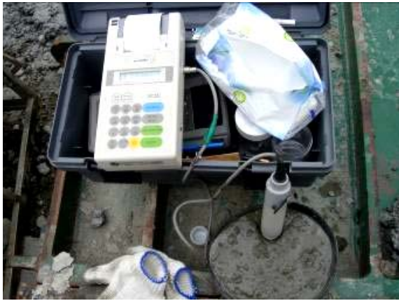
照片13 混凝土氯離子檢測
