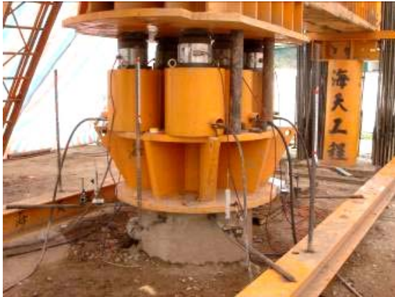
照片7 試驗樁頂裝設變位計
