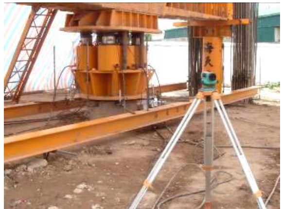
照片10 架設水準儀並量測初值
