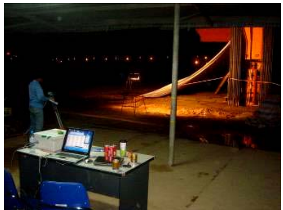
照片12 自動化量測螢幕監控與水準儀人力複測
