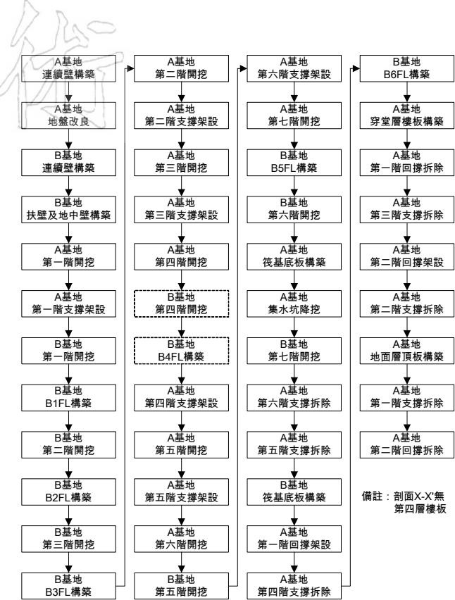
圖三 分析案例之開挖作業時程
