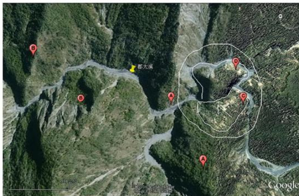
影像二 郡大溪中游的古平面型深層滑動
